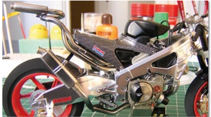
Die Auspuffanlage: Drei vordere Zylinder münden in den seitlichen Schalldämpfer, die hinteren zwei unter den Höcker.
