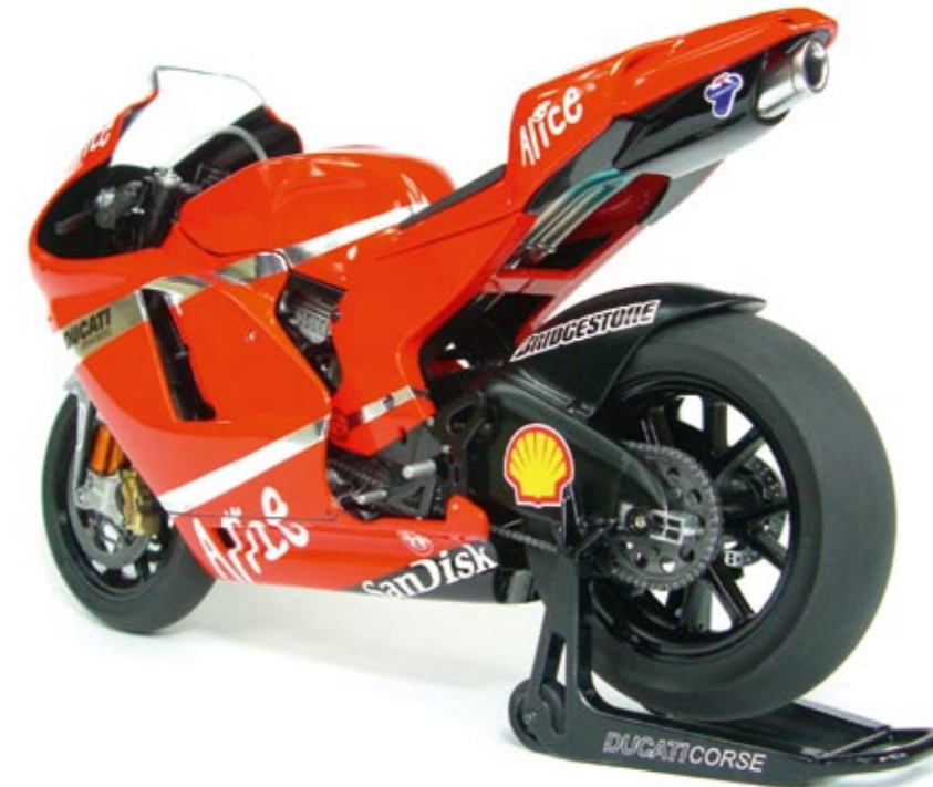
Einige der lackierten Verkleidungsteile. Die Decals sind noch nicht angebracht und der Rahmen ist noch unbehandelt.
