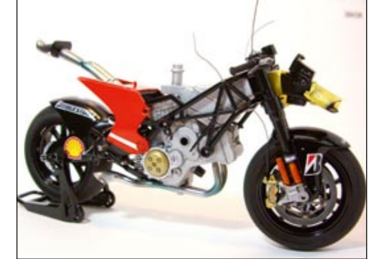
Passprobe! Der Motorblock und die Hinterradschwinge wurden sicher im Rahmen verschraubt.
