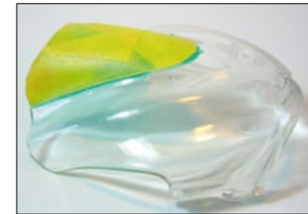
Die abgeklebte Frontverkleidung. Verkleidung und Scheibe bestehen leider nur aus einem Klarsichtteil.
