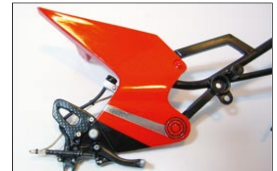
Die hintere Bremsanlage. Angegossene Plastikleitungen wurden entfernt und durch Stahlflexleitungen und Gummischläuche aus der Grabbelkiste ersetzt.
